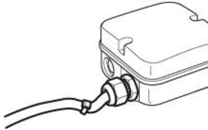
Ábra 1: Fekve beépített ventilátor, kábelfektetés vízszákként.
